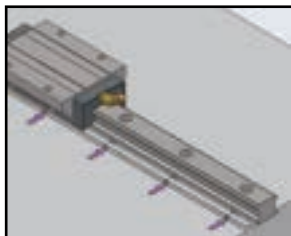
図 1.11.9 止めねじを締める
